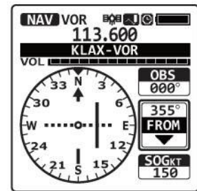
При приеме VOR сигнала в трансивере FTA-750 .
