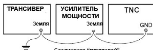
НЕПРАВИЛЬНОЕ ПОДКЛЮЧЕНИЕ ЗАЗЕМЛЕНИЯ
